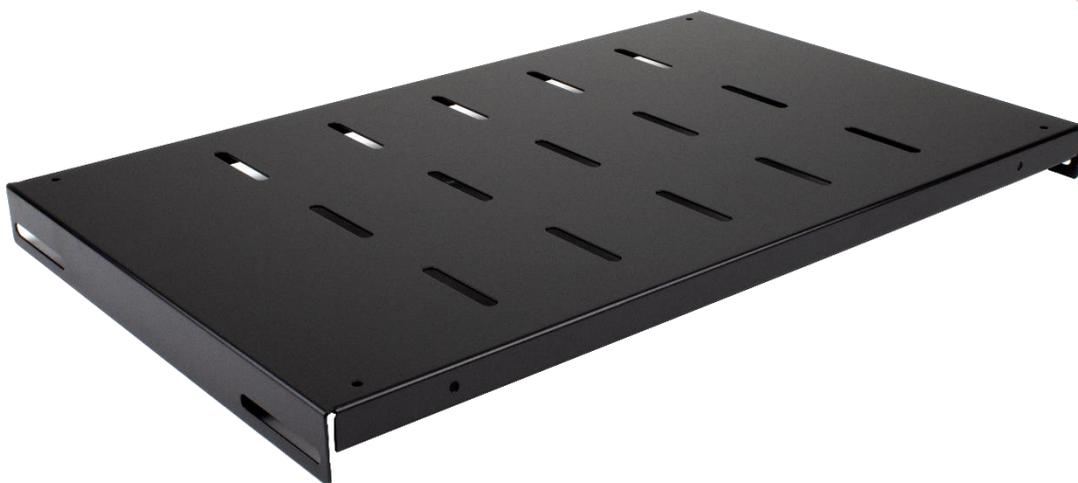
La bandeja fija rack 19" con fijación lateral en cuatro puntos de 1U de altura, se pueden usar para soportar dispositivos dentro del rack que no sean en formato rack 19", estas bandejas se colocan en los perfiles laterales de 19" con tornillería de M6, disponen de rejillas de ventilación que permite la circulación de aire a través de la bandeja. Este tipo de bandejas son válidas para ser instaladas en armarios murales de pared con F450 mm y F600 mm dependiendo del modelo.
